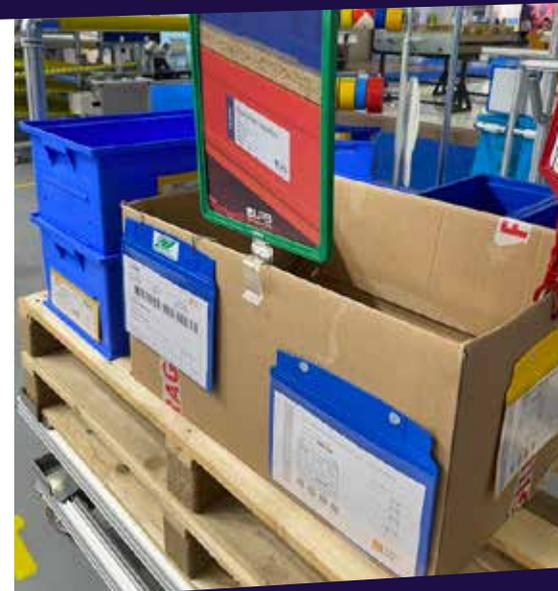
Il sistema ha il suo inizio logico nel punto di stoccaggio all'ingresso della linea finale di assemblaggio. La produzione inizia da una richiesta di prodotto finito e ogni centro funziona da fornitore per il centro a valle e da cliente per quello a monte.
