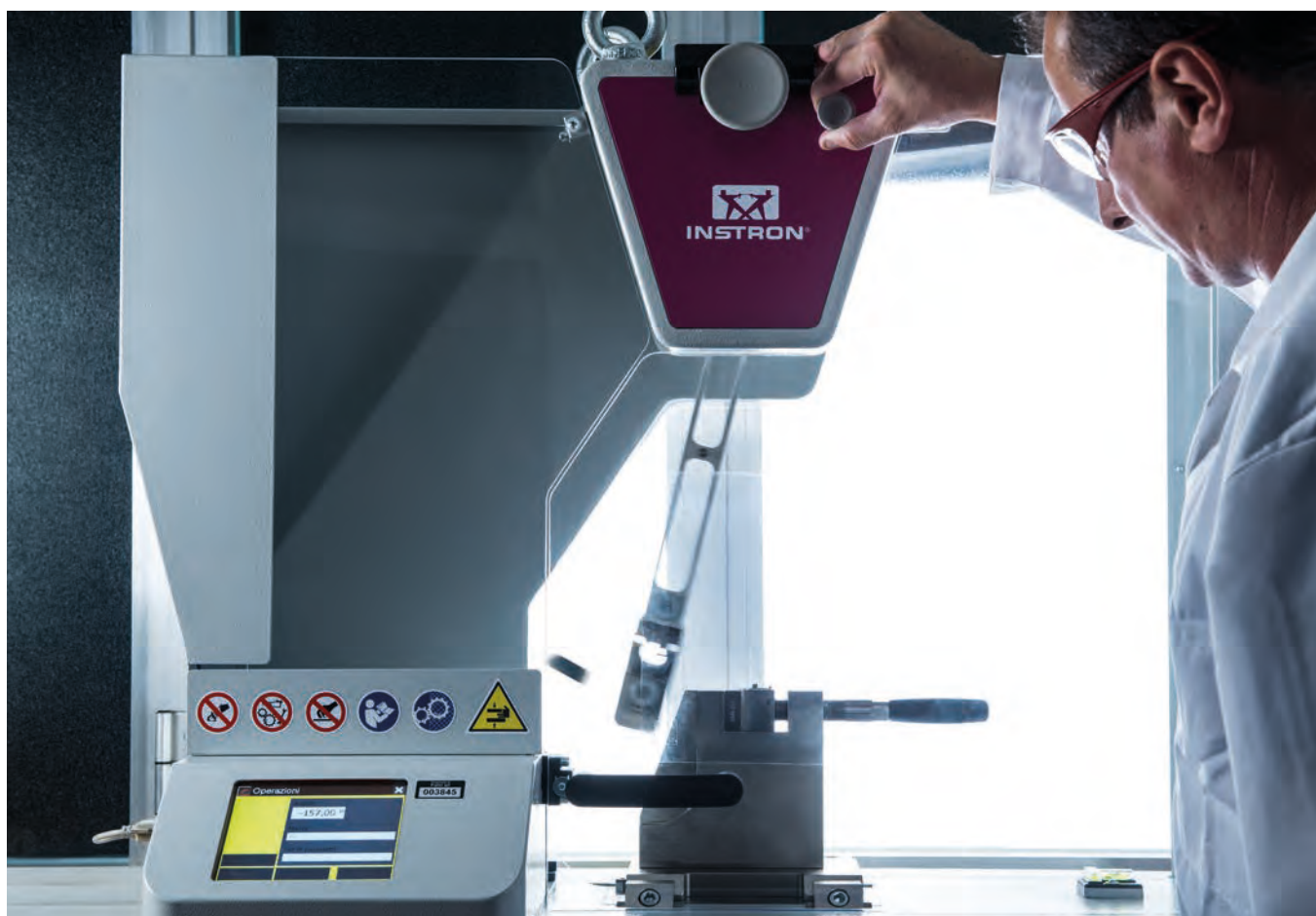
Prova d'impatto con pendolo.
